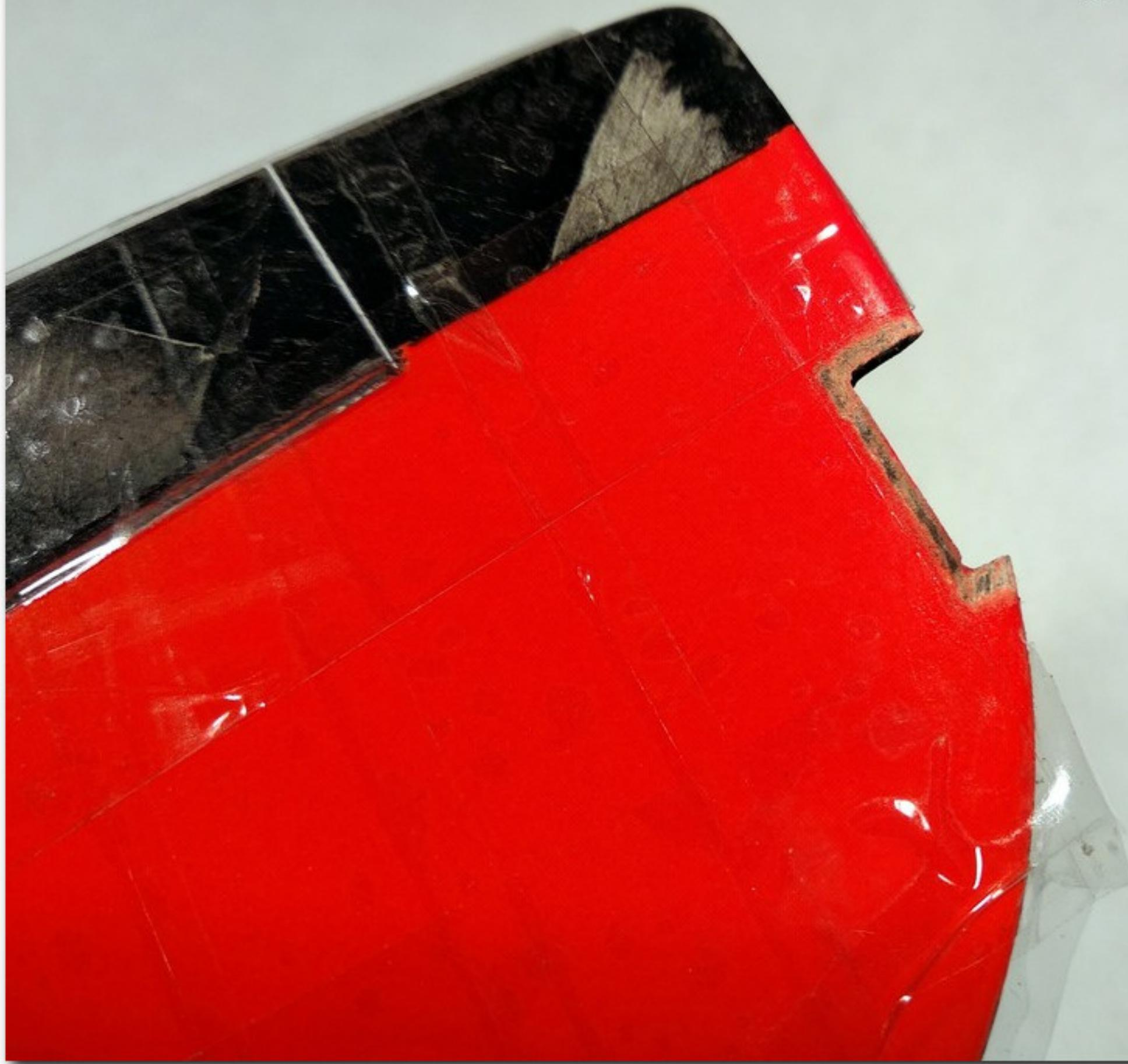
*Вклеиваем крюк на смолу с наполнителем (молотый уголь, аэросил)*
