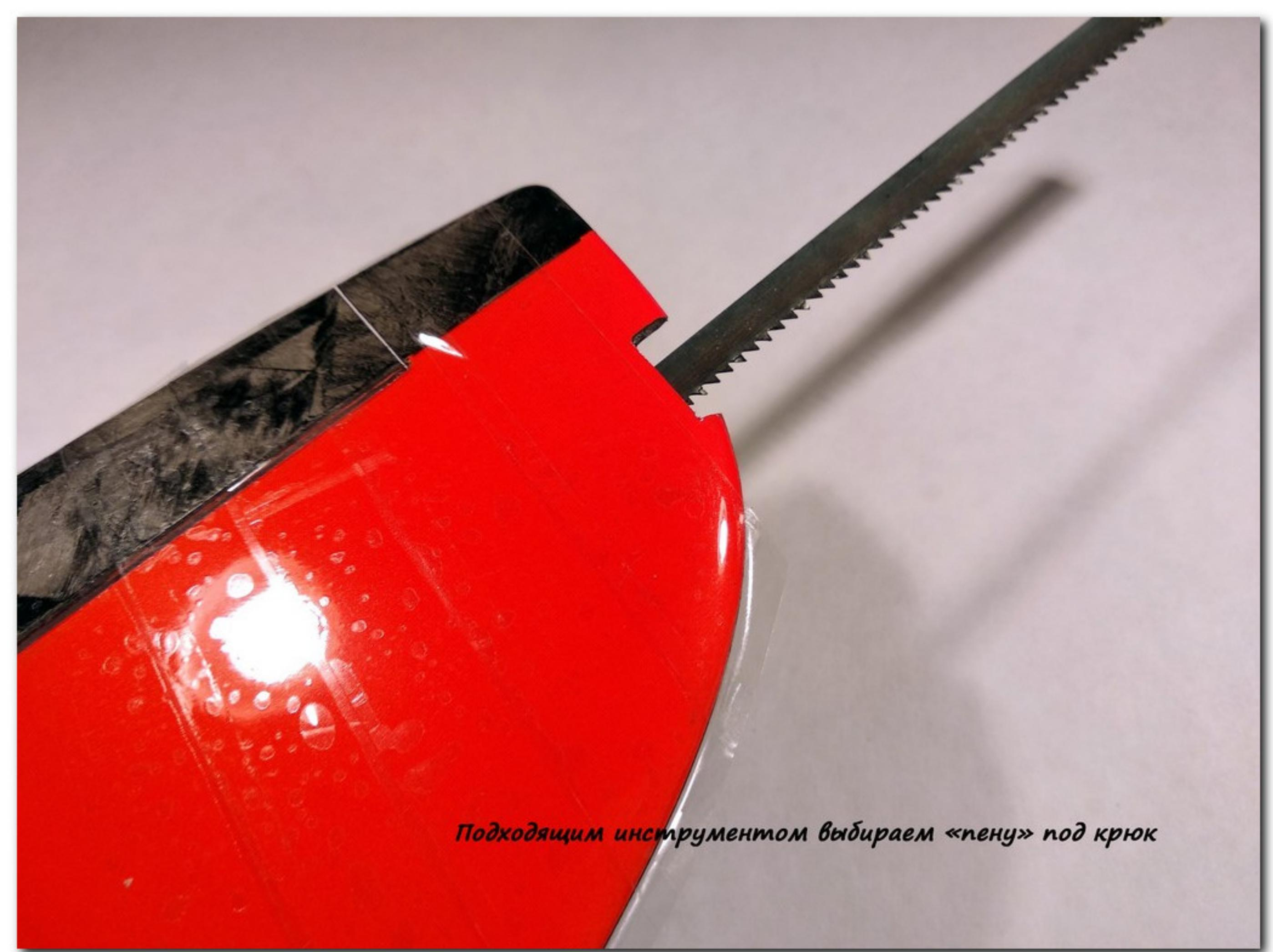
Подходящим инструментом выбираем «пену» под крюк
