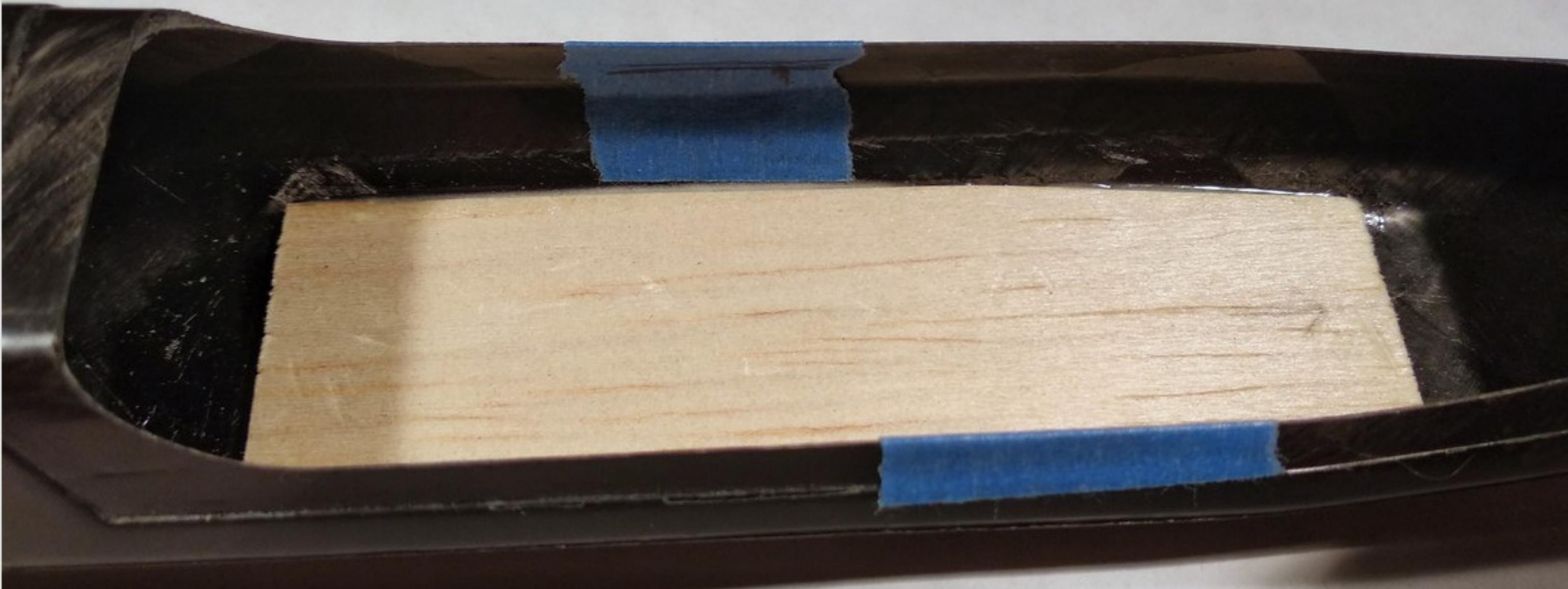
*Вклеиваем подкладку под сервоприводы*
