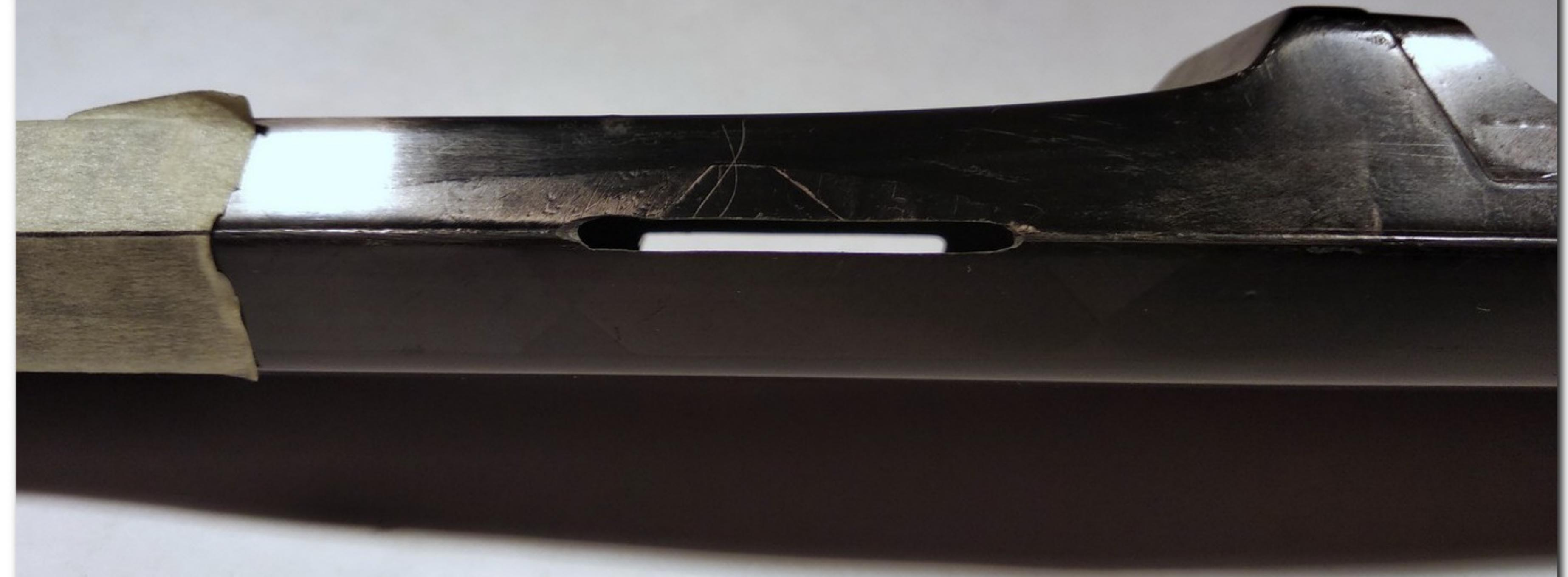
*Вырезаем отверстия под боуден элеронов*
